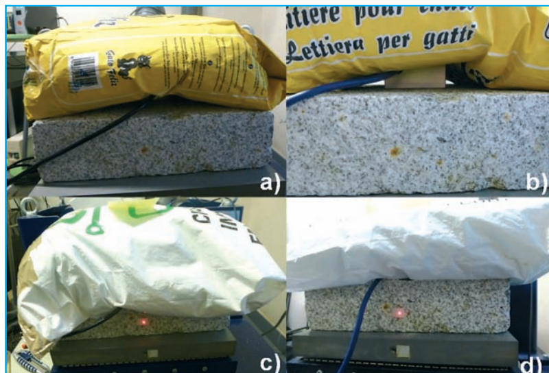
[Fig. 2].- Disposición de los sensores sujetos con sacos a bajas-SB (a-b) y altas-SA (c-d) velocidades.
